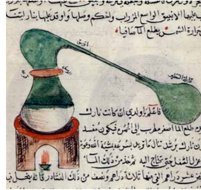
Kimya konulu 18.yüzyıl el yazısından damıtma işlemi. Arapça metinde çeşitli kaplardan ve imbikten bahsedilmekte, yoğunlaşan sıvının üstteki soğutma kabından cam balona akışı anlatılmaktadır.
