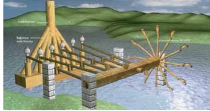
Takiyyüddin'in altı silindirli su pompası.
